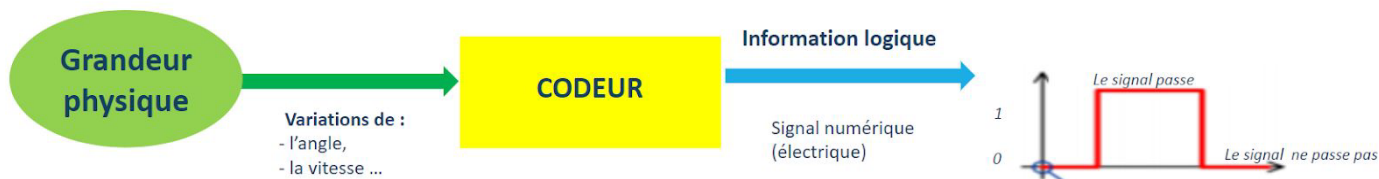
Principe de fonctionnement d'un codeur
